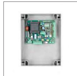
Uitgebreide motorsturing 230 Vac Ingebouwde ontvanger 433,92 Mhz Programmering van diverse logische functies via display Historie uitleesbaar Met standaard 8K2 ingang Standaard ingang voor encoder
